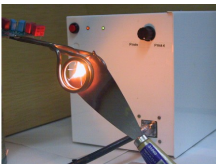
Nagrzewnica indukcyjna (praca magisterska IR PW)
